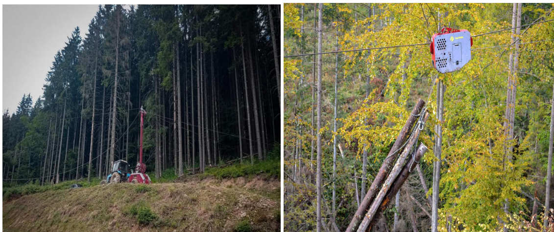
Рис. 11. Використання повітряно-трелювальної канатної установки фірми «Тайфун» для переміщення лісопродукції в умовах філії «Вигодське лісове господарство» ДП «Ліси України» (фото Ткачук О.М.).
