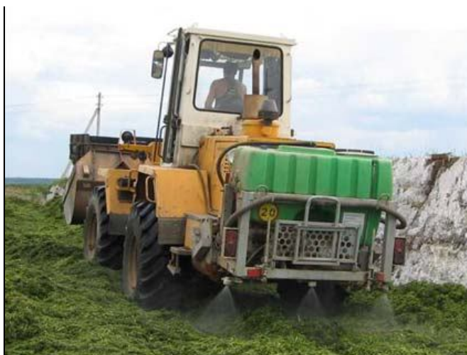
Рис. 1. Оборудование для загрузки кормов в траншейные хранилища и внесения консервантов (Амкодор 332С + БОВК-400).
