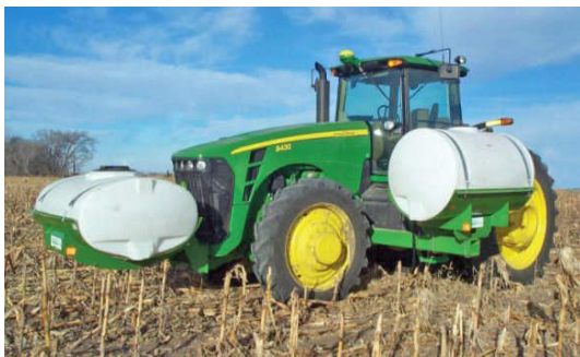
Рис. 9. Общий вид трактора и элементов крепления до 400 галлонов (1514 л).
