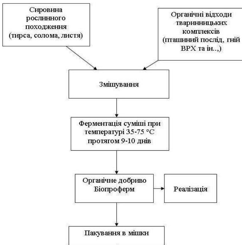
Рис.1. Схема виробництва органічного добрива «Біоферм».
